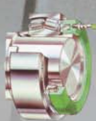
Matice HMV E pri demontáži sťahovacieho púzdra
