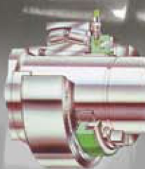
Matice HMV E a zastavova. krúžky pri demontáži sťahovacieho púzdra
